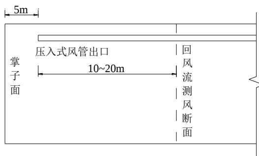
图 J.2 风速测点布置断面
